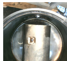
L'utilisation de l'Effinox empêche la formation de cristaux et assure le bon fonctionnement du système SCR
