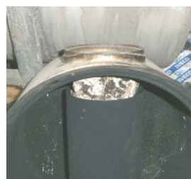
Des cristaux d'urée se déposent et finissent par obstruer l'échappement
